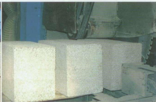
Рис. 3. Резка полистирольного массива на калиброванные блоки
