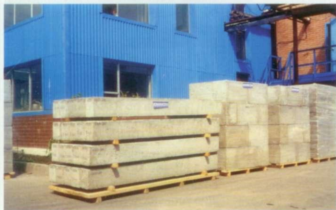
Рис. 2. Готовые полистиролбетонные изделия завода ЗАО «ЮНИКОН-ЗСК» (перемычки, блоки, плиты)
