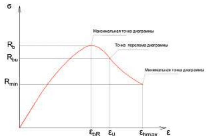
Рис. 2. Основные параметрические точки диаграммы деформирования « \sigma – \varepsilon » бетона при сжатии
