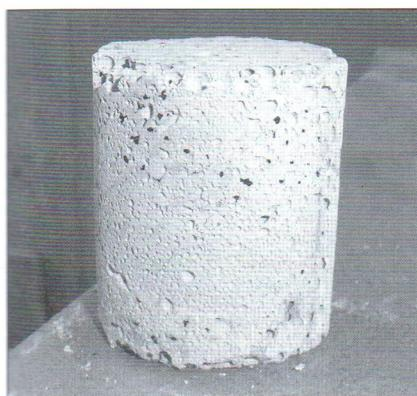
*Образец из полистиролбетона после испытания на горючность*
